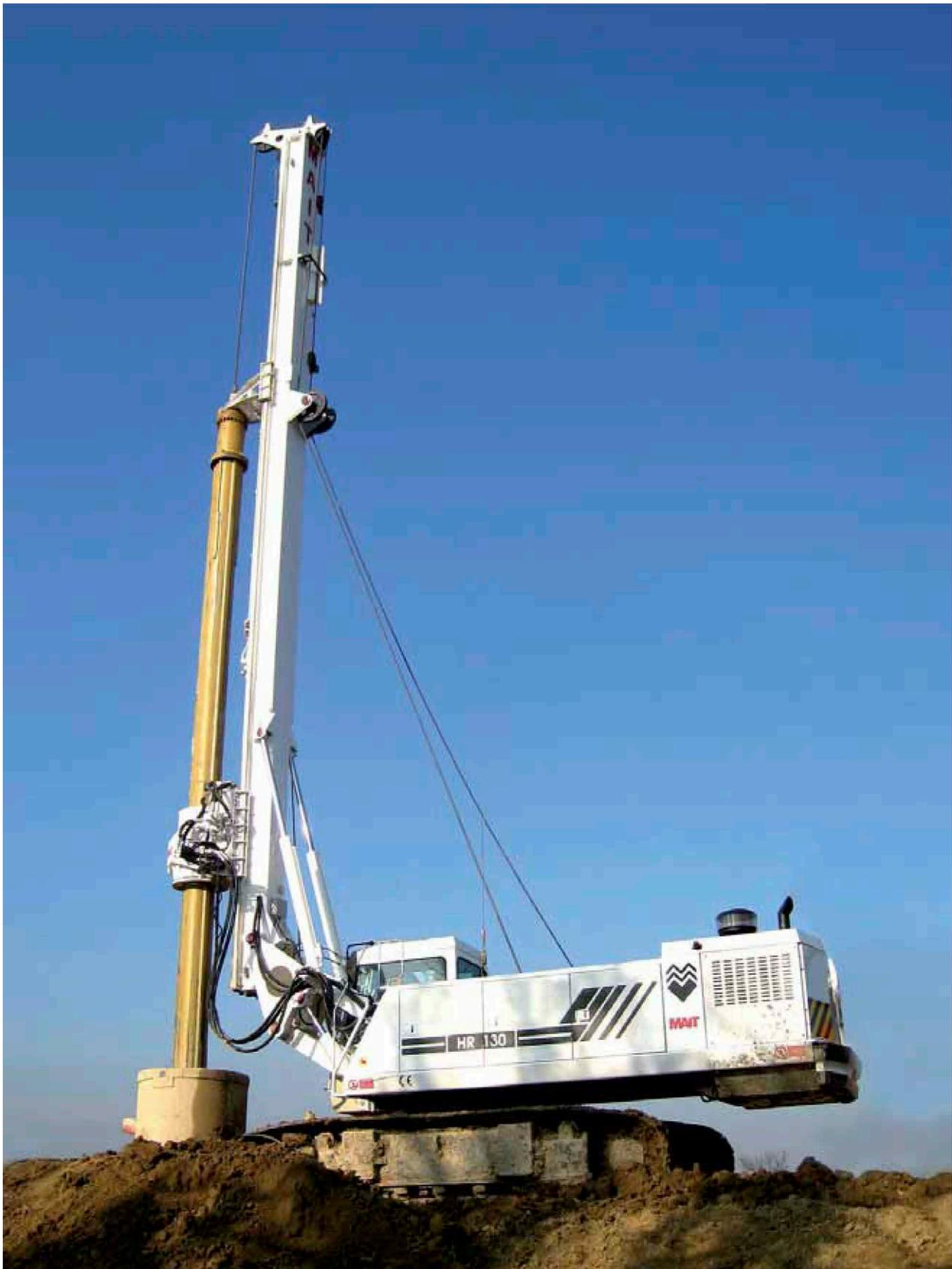
La HR 130 est équipée avec un cylindre de traction-poussée (version PC) qui permet une course de la tête de rotation de 4.300 mm (14 ft) le long du mât. Le couple élevé permet à la machine de forer jusqu'à un diamètre de 1.800 mm (6 ft) avec la tige de perforation (kelly).
