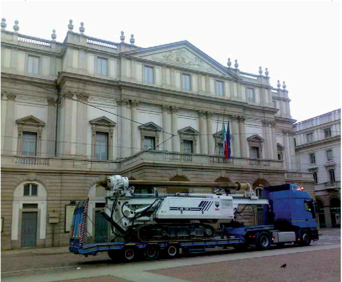
Le HR 130 est une machine puissante et robuste, mais elle est aussi très compacte. Elle a été spécialement conçue et destinée à réduire les dimensions globales de la machine sans compromettre ses caractéristiques supérieures de travail. Cette machine ne nécessite pas le démontage pour être transportée et elle peut être facilement et rapidement transformée pour différentes applications par le montage directement à la machine des kits spécialement conçus.
