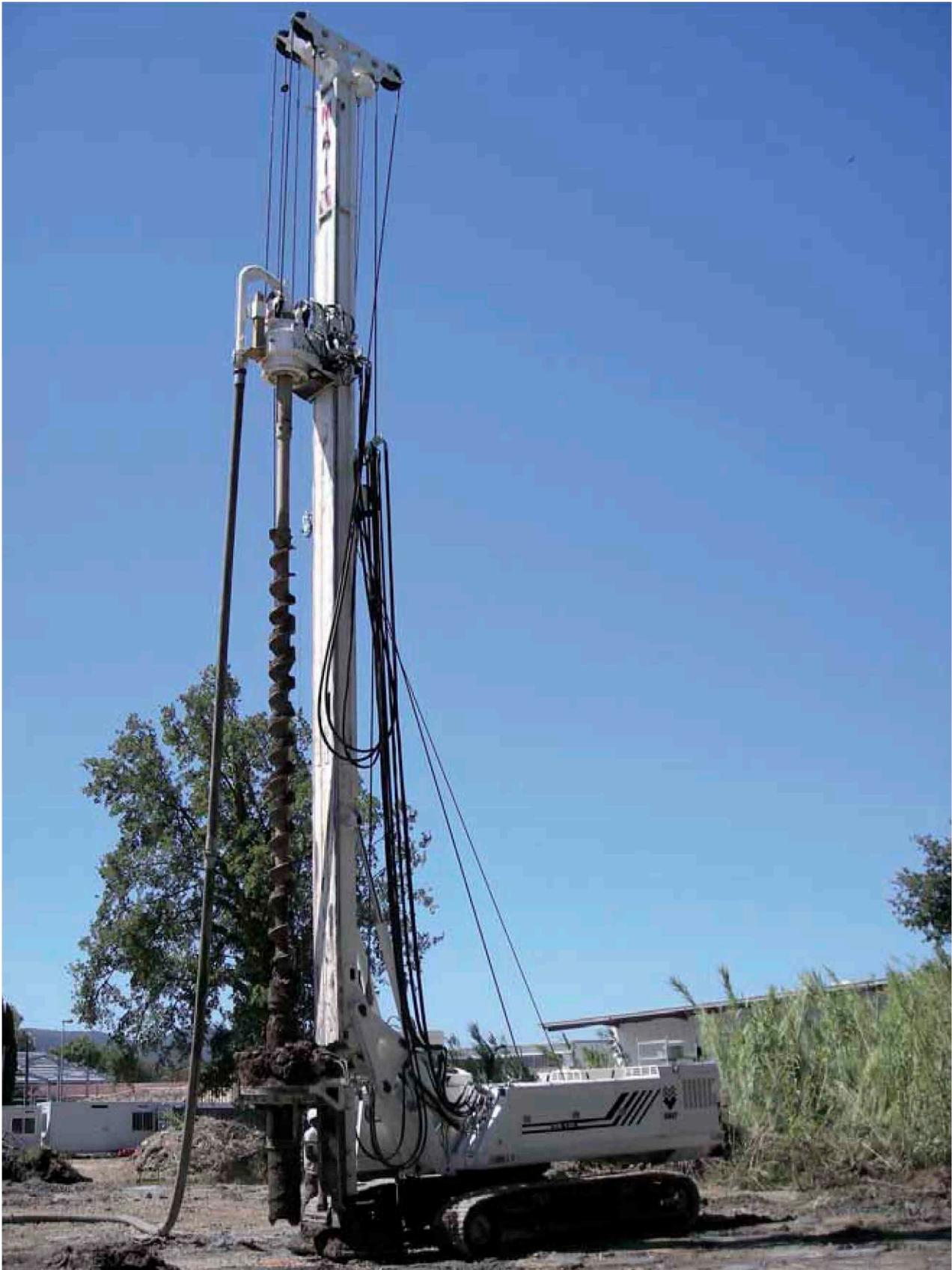
La HR 130 avec le kit pour Tarière Continue peut forer jusqu'à un diamètre de 800 mm (2.6 ft) et jusqu'à une profondeur maximum de 19 m (61 ft). Une large sélection d'accessoires CFA sont disponibles en option, y compris, nettoyeurs hydrauliques pour la tarière, système informatique pour l'enregistrement et la surveillance des paramètres CFA, treuils de poussée, etc.
